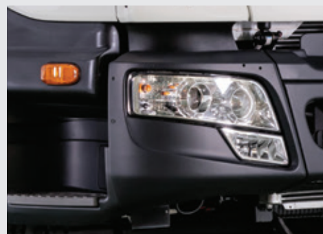
Đèn chiếu phản xạ đa chiều được trang bị đèn Projector
