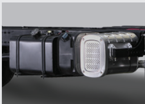
Thùng nhiên liệu & bộ xử lý khí thải
